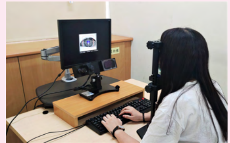
▲眼動儀的紅外線鏡頭會偵測瞳孔與角膜反射來追蹤並記錄我們的眼動軌跡
